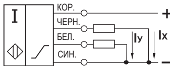
Схема подключения с пропорциональными выходным током
